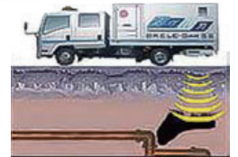
路面下空洞調査のイメージ
